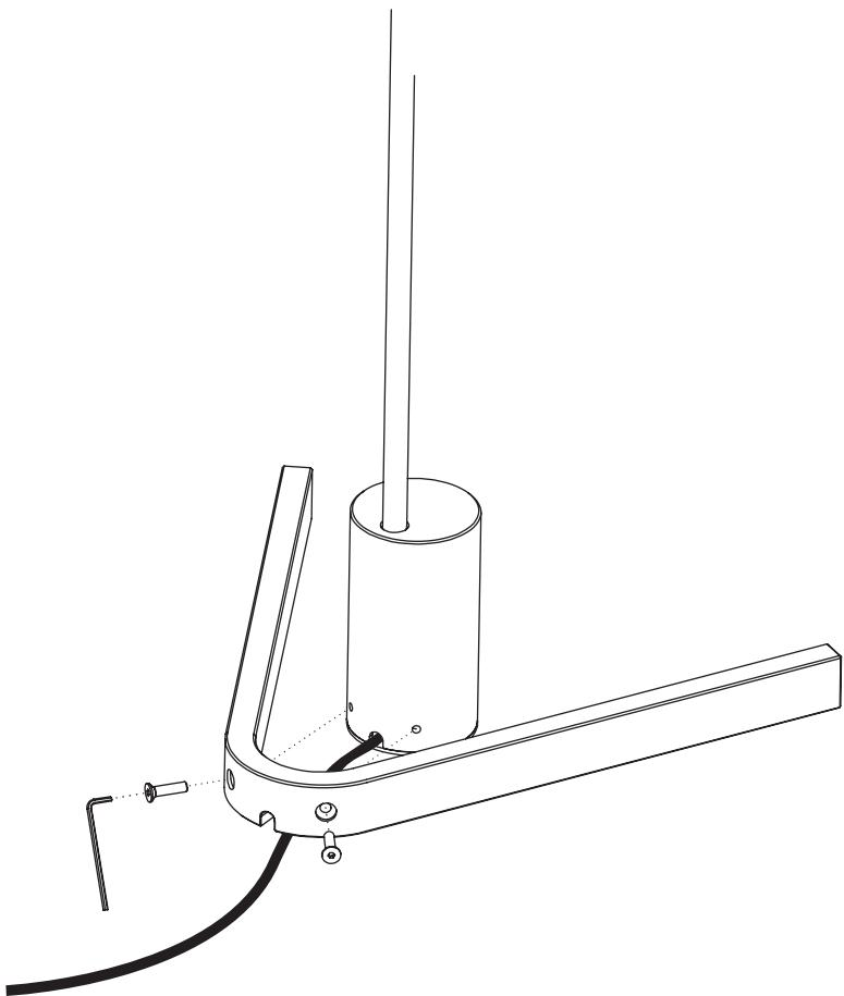
**Fixez la base sur le corps de la lampe à l'aide des vis**
